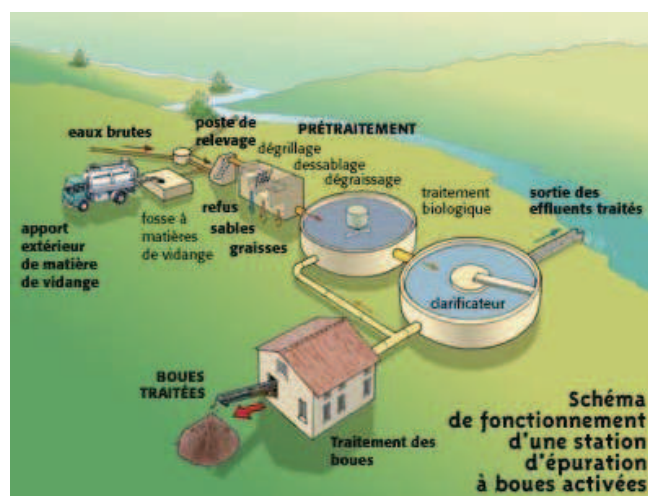
Principe de fonctionnement d'une station d'épuration
